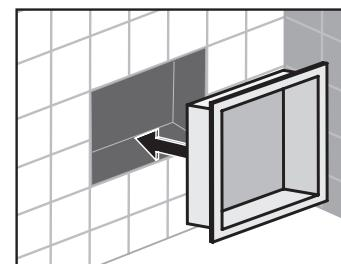
7 Umetnite učvršćenje niše u šupljinu. Čvrsto pritisnite prirubnicu i osigurajte visinu i razinu niše. Preporučuje se brtvljenje praznine između prirubnice i pločice.
