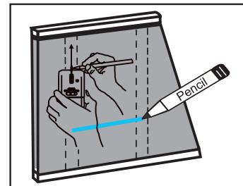
1 Locirajte i označite središnje linije susjednih klinova okvira koristeći detektor metalâ ili lupkanjem po zidu. Povucite liniju razine između dva klinâ na željenoj visini nišâ.
