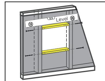
4 Nanesite vodonepropusnu izolaciju na sve strane unutar unaprijed pripremljene rupe u zidu. Pravilno postavljanje vodonepropusne izolacije vrlo je važno!
