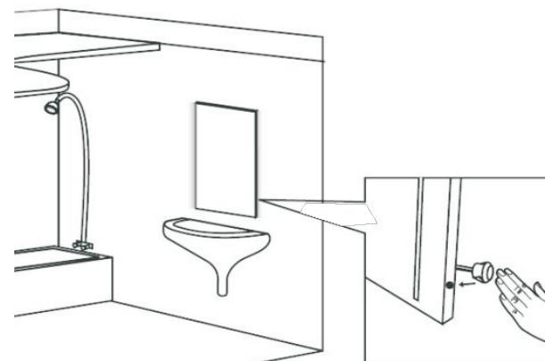
**⚠️** Molimo vas da osigurate da su svi senzori najmanje 200mm udaljeni od čvrstih površina uključujući zidove.
