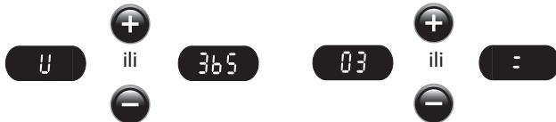
Ako se na LED zaslonu prikaže „U“, pritiskom na tipku Pumpa 1 sustav za sanitizaciju prelazi s „U“ na „O3“ nakon čega se izlazi iz izbornika programiranja.
