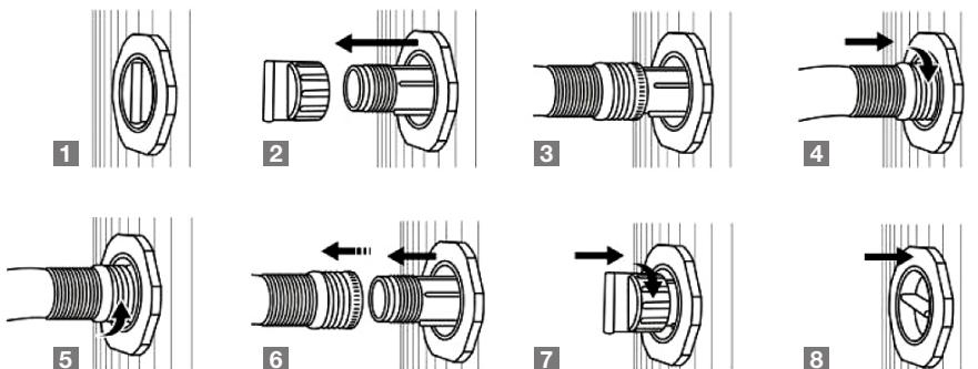
1/ Cijev odvoda u zatvorenom uvučenom položaju.
