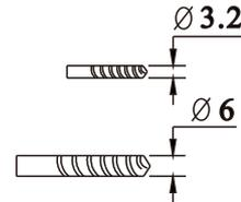
( $\varnothing 6$   $\varnothing 3$  2) SVRDLA ZA BUŠILICU
