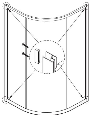
**1** Postavite čepove (10) na kraje spojnih profila. Postavite spojni profil (4) i 2 tračnice koristeći M4x30 vijke da dobijete okvir.
