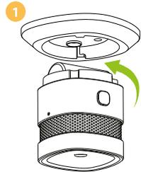
Drehen Sie den Sensor gegen den Uhrzeigersinn, um ihn von der Halterung zu lösen.
