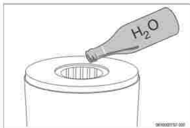
Sl. 69: Isplivanje toplinskog bloka vodom
