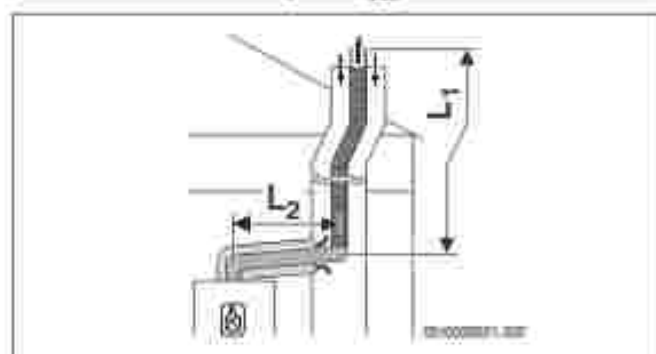
Sl. 20 Fleksibilna izvedba prema C 93x u oknu i koncentrični dovod zraka/odvod dimnih plinova u mjestu postavljanja
