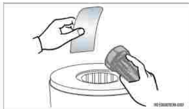
Sl. 68: Provjera ostataka u toplinskom bloku
