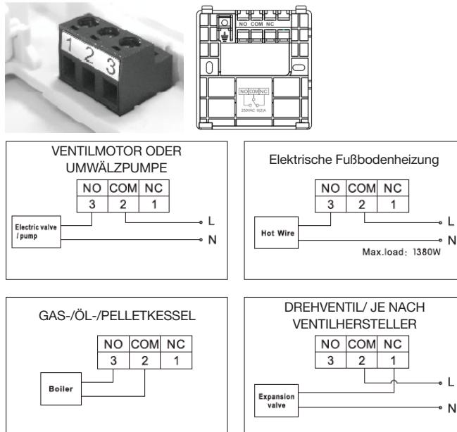
**Heizen / Kühlen:** Verbinden Sie die beiden Anschlussleitungen des zu steuernden Geräts an den Klemmen 3 (NO) und 2 (COM), das heißt an die normalerweise geöffneten Kontakte des Relais.
