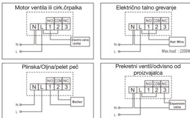
Napetost na sponkah št.1 in št.2 je odvisna samo od krmilnega sistema, velikost žice je določena z vrsto naprave, ki jo je treba nadzorovati. Dolžina niti ni pomembna, sprejemnik se lahko namesti blizu ali daleč od grelnika vode, ne pod njegovim ohišjem. Če je razdalja med oddajnikom in sprejemnikom prevelika, lahko brezžična (radijska frekvenca) povezava postane nezanesljiva. Sprejemnik namestite čim bližje točki termostata.
