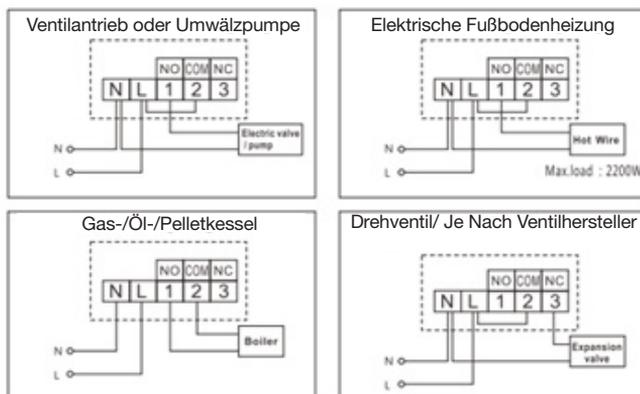
Die Spannung an den Anschlüssen 1 und 2 hängt allein vom Steuersystem ab; die Drahtgröße wird durch die Art des gesteuerten Geräts bestimmt. Die Länge ist nicht wichtig; der Empfänger kann in der Nähe oder weit entfernt vom Kessel installiert werden, darf jedoch nicht unter seinem Gehäuse sein.
