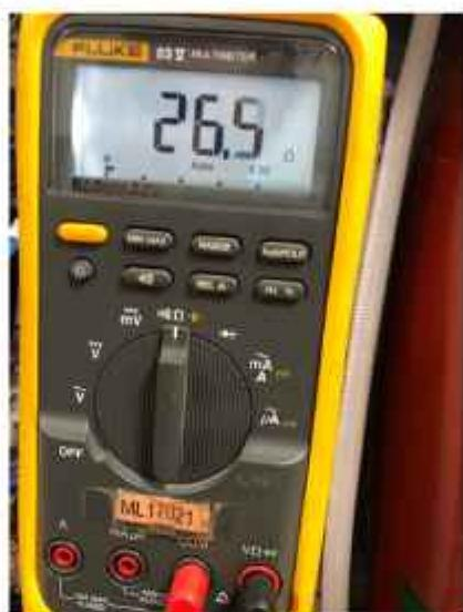
d- Ako nema gubitaka kontakta u kabelima i otpor otpornika je u okviru normalnih vrijednosti, uzmite mjere drugih otpornika u istoj skupini. Ako nema protoka struje u svim otpornicima jedne skupine, provjerite jesu li kabeli releja neoštećeni i spojeni i na strani releja i na matičnu ploču. Na matičnoj ploči, ovi kabeli trebaju biti spojeni na sljedeće priključke:
