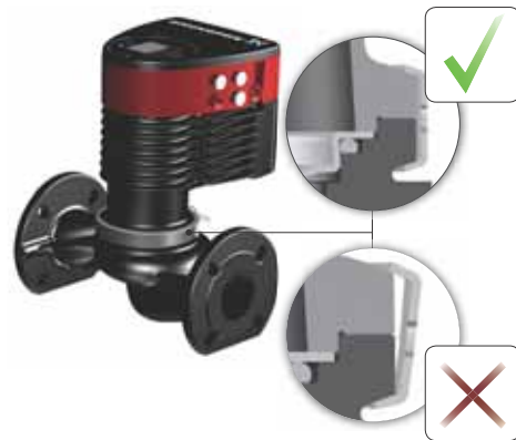
Slika 15 Montaža glave crpke na kućište crpke
