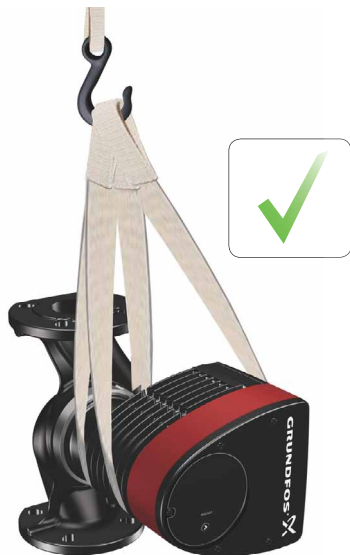
Slika 5 Pravilno dvigovanje črpalke
