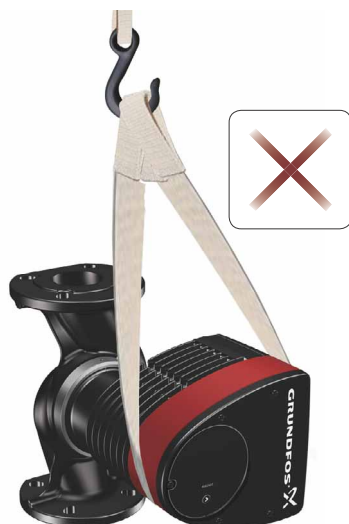
Slika 6 Neispravno podizanje crpke
