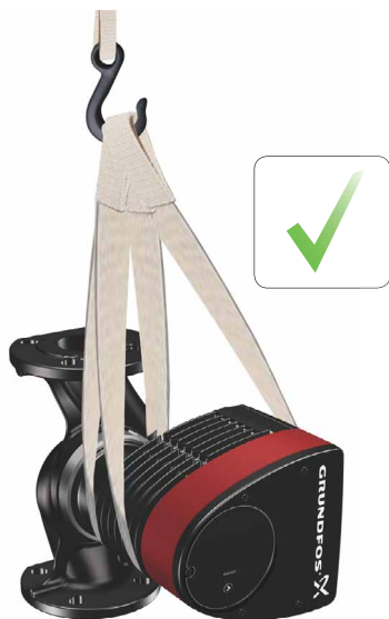
Slika 5 Ispravno podizanje crpke
