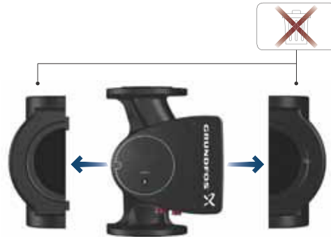
Slika 8 Skidanje izolacijskih obloga s crpke
