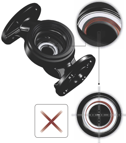
Slika 12 Neispravno centriran sustav brtvljenja
