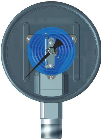
Die Kapselfedern bestehen aus kreisförmig gewellten Membranen, die am Rand druckdicht gefügt sind. Der Messdruck wird im Zentrum eingeleitet und wirkt auf die Innenseite der Membrane. Die hierdurch erzeugte Hubbewegung ist ein Maß für den Druck.
