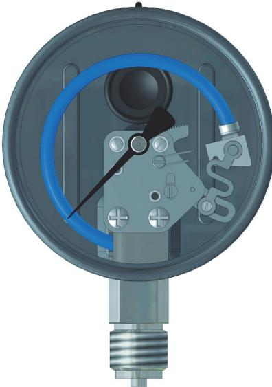
Diese Produkte enthalten Messglieder (Rohrfedern), die sich unter dem Einfluss eines Druckes elastisch verformen. Diese Bewegung wird auf ein Zeigerwerk übertragen.
