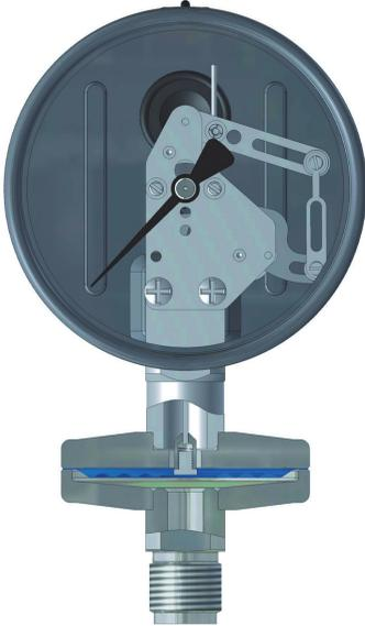
Die Plattenfedern sind kreisförmig gewellte Membranen. Sie werden einseitig von dem zu messenden Druck beaufschlagt. Die Durchbiegung der Membrane ist ein Maß für den Druck.
