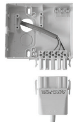
Abb. 91 Der Anschluss erfolgt über die im Lieferumfang enthaltene Wandanschlussbox. Versehen mit einer als Zubehör erhältlichen Spritzwasserschutzabdeckung lässt sich die Schutzart auf IP 44 erhöhen.
